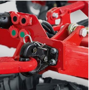
Zugmaul mit hydraulischen und elektrischen Anschlüssen
