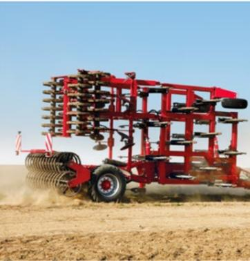
Schwenkfahrwerk in Transportstellung
