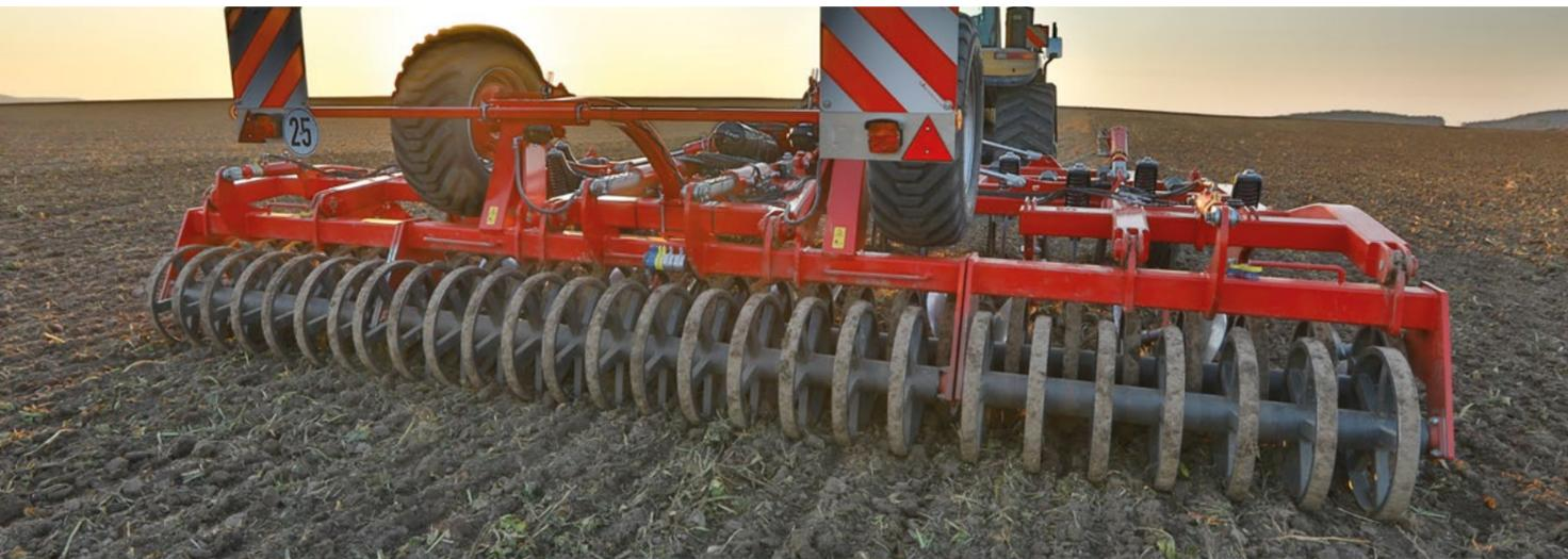
Optional: Doppel RollPack Packer für mittelschwere und schwere Böden mit guter Zerkleinerungs- und Rückverfestigungsleistung
