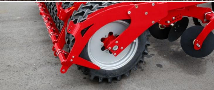
Optional großer Reifenpacker (Durchmesser von 1 m) für sichere Tragfähigkeit auf leichten Böden mit AS-Profil
