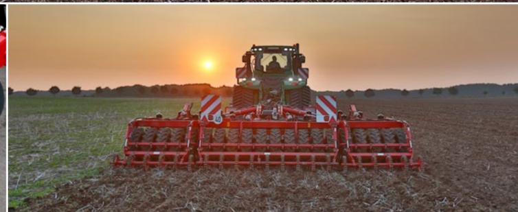
Rückverfestigung: Reifenpacker mit hoher Tragfähigkeit und tiefgehender Rückverfestigung und optionaler TopRing Packer für hervorragende Oberflächenstruktur
