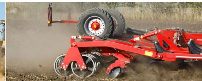
**Schwenkfahrwerk in Arbeitsstellung**
