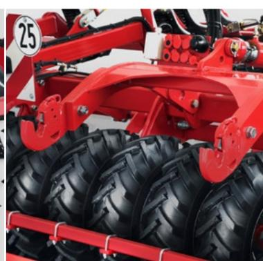
Unterlenker Anbaurahmen mit hydraulischen und elektrischen Anschlüssen
